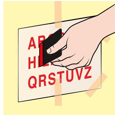
Con l'ausilio di una spatolina fare aderire con cura il prespaziato alla superficie.
